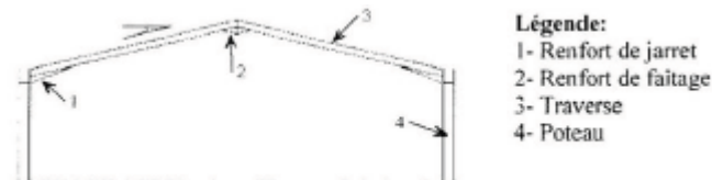
Figure III.11 : Portique symétrique à une travée.
