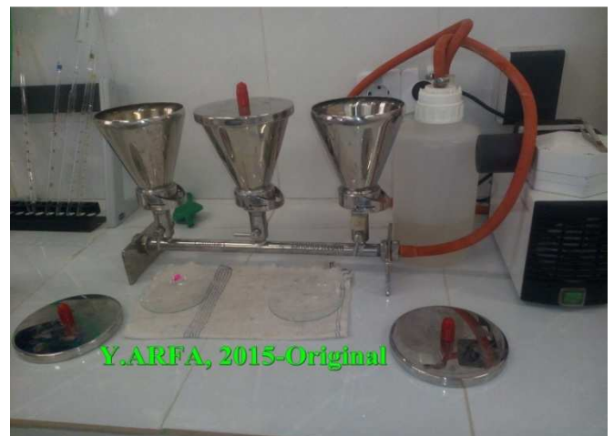
Photo 20: Filtration sous pompe à vide.
