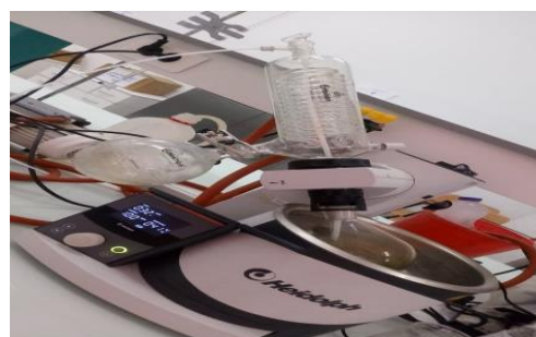
Photo 11 : Dispositif d'évaporation de Méthanol.
