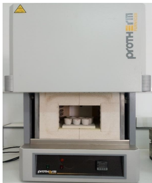
Photo 04 : Séchage des extraits dans le four pendant 60 min à 50°C
