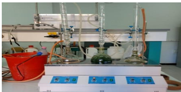
Photo 10 : Dispositif d'extractions des principes actifs par reflux.
