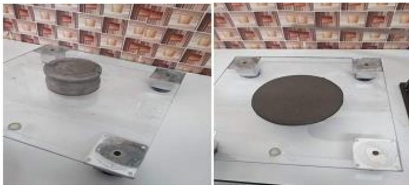
Figure (I.04) : Essai au mini cône
