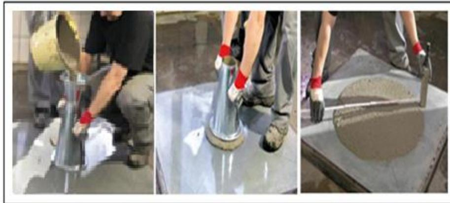
Figure (I.01) : Détermination de l'étalement [26].
