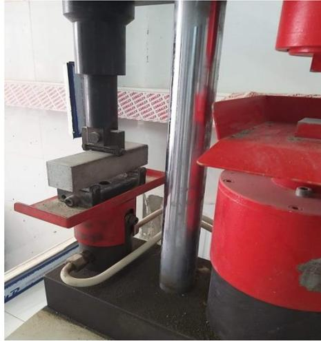
Figure (I.06) : Essai de la résistance à la flexion
