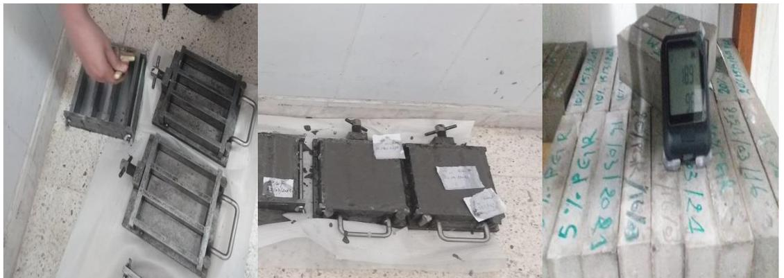
**Figure (III.14):** Etapes de préparation les éprouvettes  $(40 \times 40 \times 160)$  mm<sup>3</sup>
