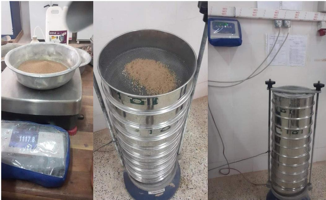
**Figure (III.08) :** Analyse granulométrique par tamisage
