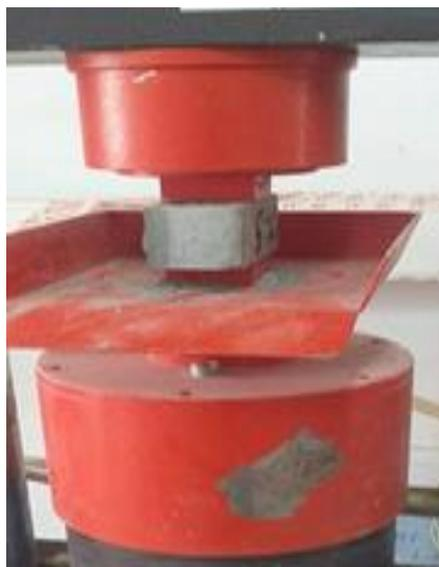
Figure (I.07) : Essai de la résistance à la compression
