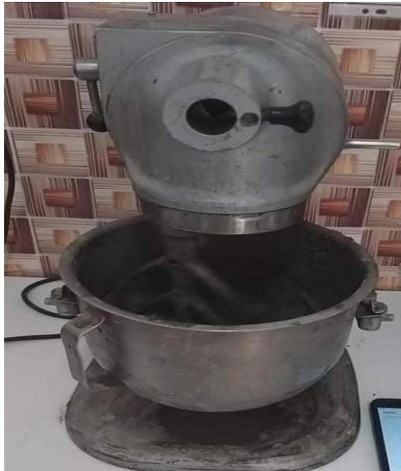
**Figure (III.10) : Malaxeur de mortier**
