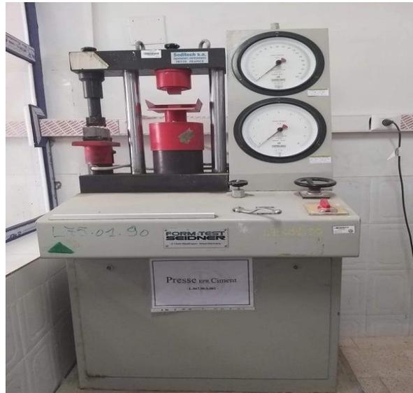
**Figure (III.13) :** Appareil des résistances mécaniques à la flexion et à la compression
