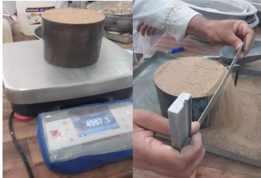
**Figure (III.06) : La masse volumique apparente**
