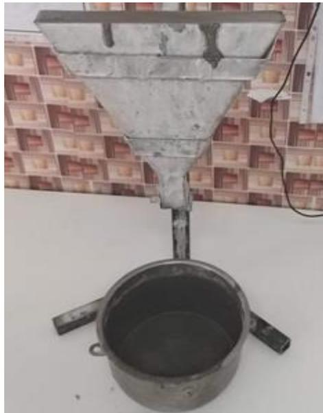
Figure (I.05) : Essai De Déformabilité De l'Entonnoir En V (V-Funnel).
