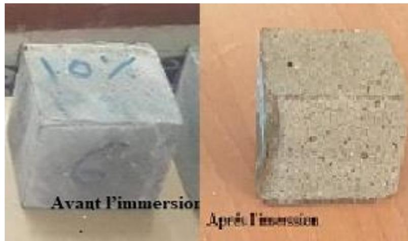
Figure (IV.05) : examen visuel sur l'échantillon immergé dans  $H_2SO_4$
