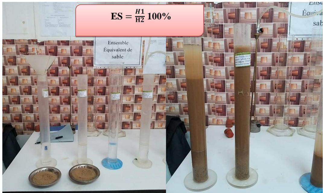
**Figure (III.07) : Equivalent de sable**
