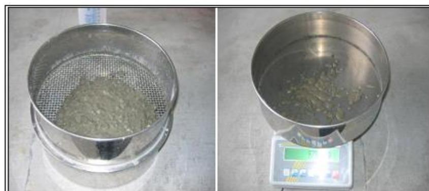
Figure (I.03) : Essai de stabilité eu tamis [26].
