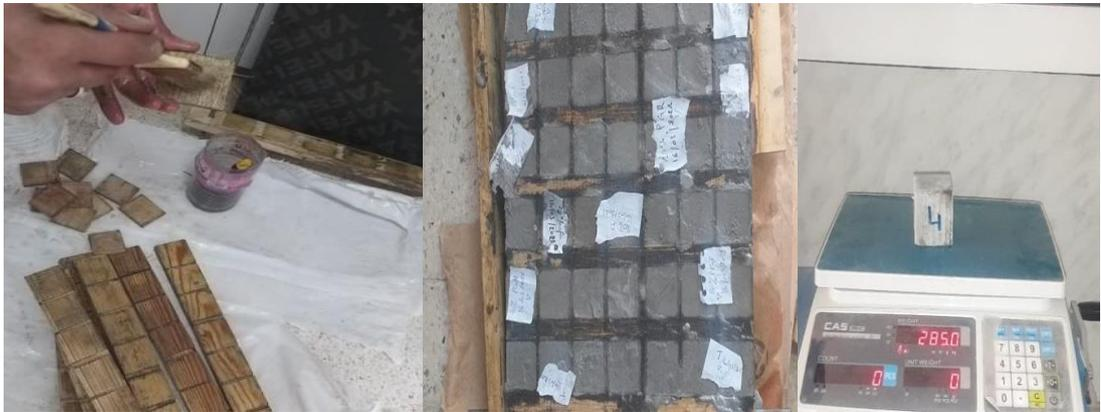
**Figure (III.15):**Etapes de préparation les éprouvettes (50×50×50) mm<sup>3</sup>
