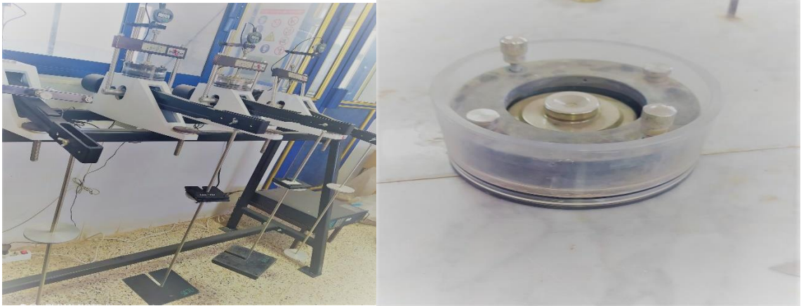
Figure III.8 : Appareillage de l'essai œdométrique.
