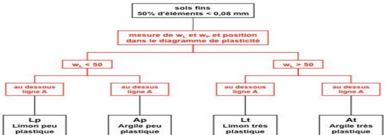
Figure III.21 : Diagramme de classification pour les sols fins dans la classification LPC modifiée.
