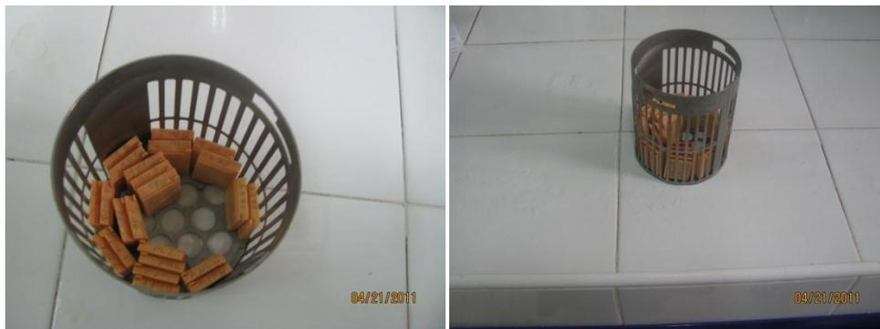
**Figure n°16:** Dépôt des cassettes dans le filet de l'appareil de déshydratation.
