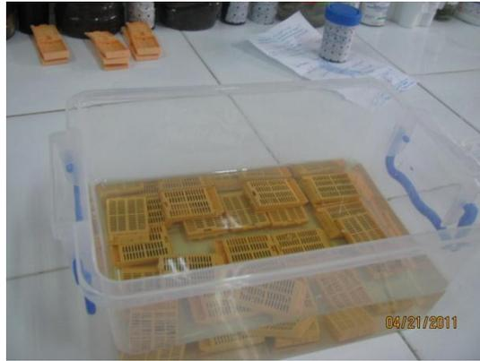
**Figure n°15 :** Fixation des échantillons dans du FAA.
