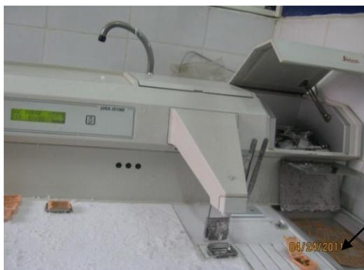
**Figure n°18 :** appareil d'enrobage.
