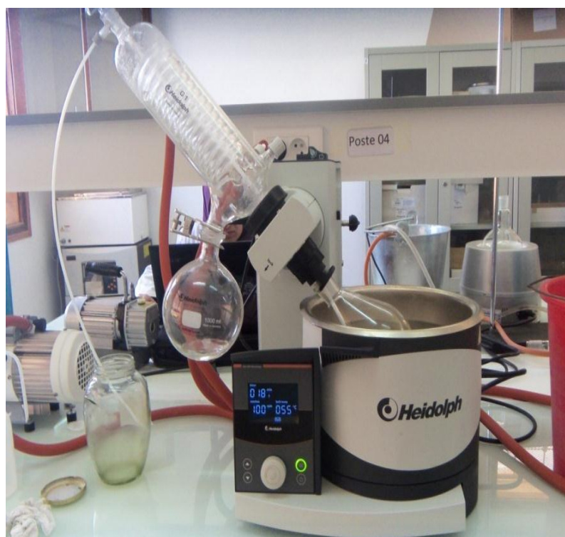
Photo 5 – Rotor vapor de type Heidolph (Original).
