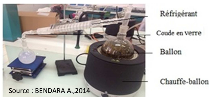
Photo n° 3 : Montage d'hydrodistillation pour l'extraction des huiles essentielles.
