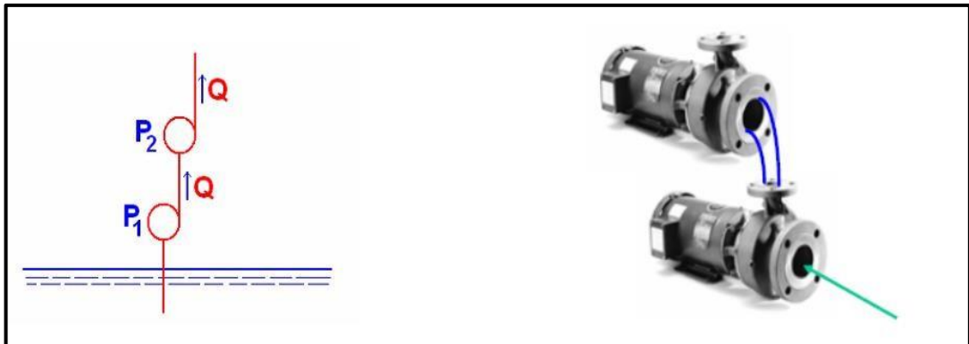
Figure 8 : Système de couplage en série.
