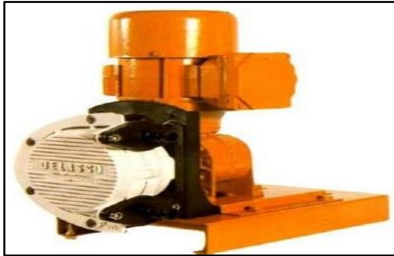
Figure 6 : Pompe volumétrique (rotative).
