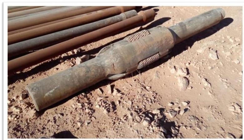
Figure. N°12 : Outil d'ELARGISSAGE DU TROU.
