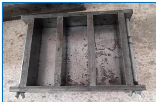
**Figure (III.15) :** les moules de mortier.
