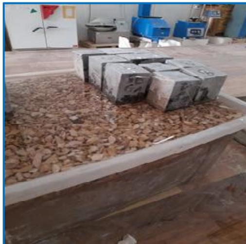
**Figure (III.19) :** Essai d'absorption d'eau
