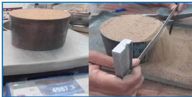
**Figure (III.04) :**La masse volumique apparente
