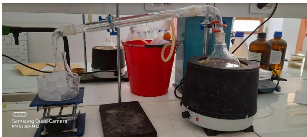
Figure 12 : Montage d'hydrodistillation utilisé.
