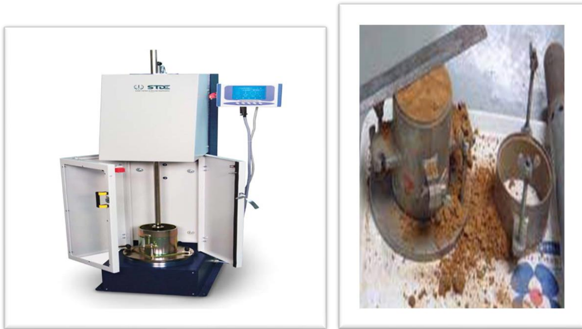
Photo III-3 : Matériel de Proctor modifié. Ok
