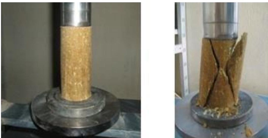
Figure II – 14 L'éprouvette soumise à l'essai de compression jusqu'à la rupture.
