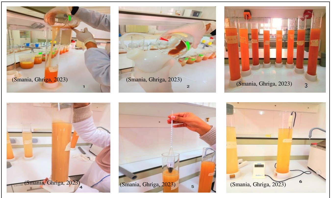
Figure 11. Etapes de mesure de la densité de liquide par le densimètre de Bouyoucos.
