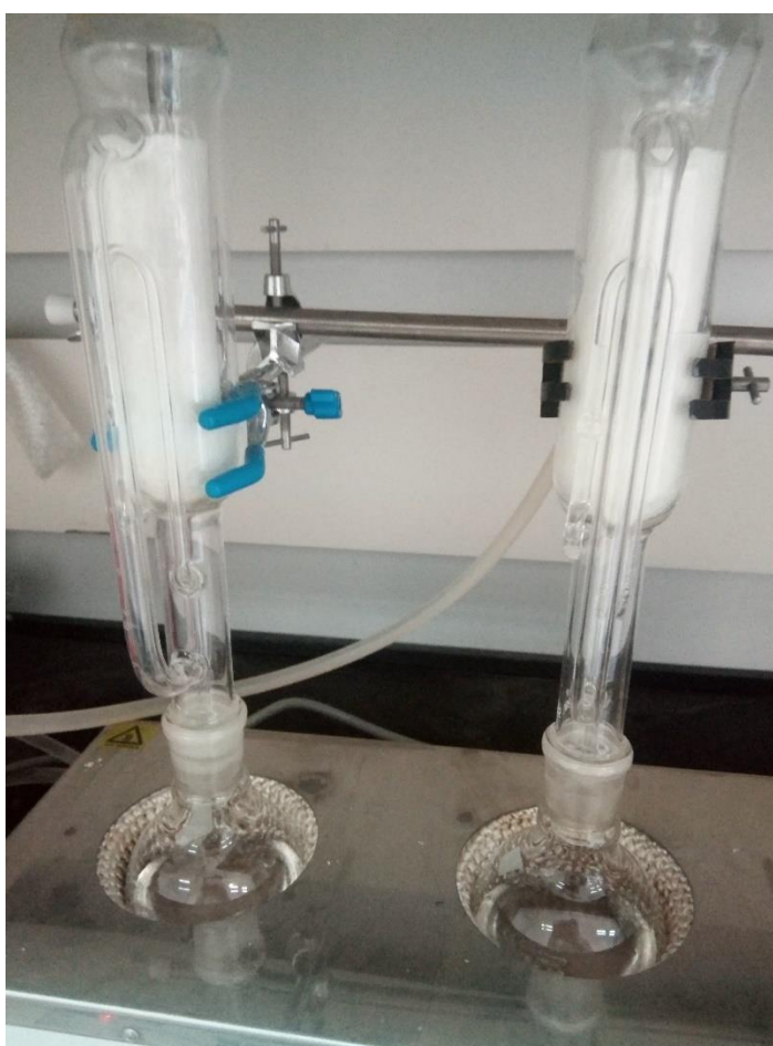
Figure 16 : Processus d'extraction huile de grain de coloquinte.
