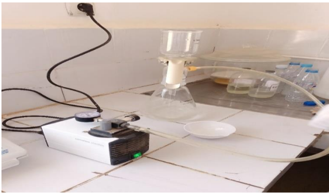
Système de filtration à pompe sous vide
