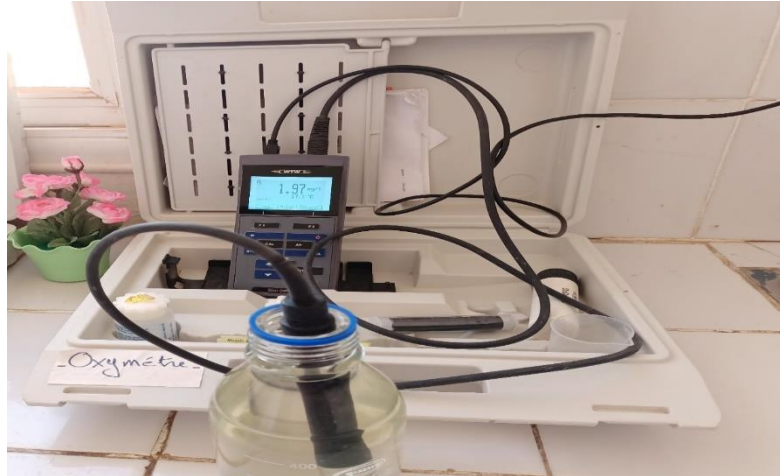
Figure 5.V: La mesure de l'oxygène dissous par l'Oxymétrie 3310
