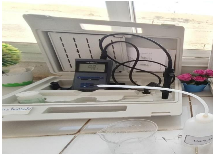
Figure 4.V:La mesure de la conductivité, la salinité et de température par conductimètre 3110
