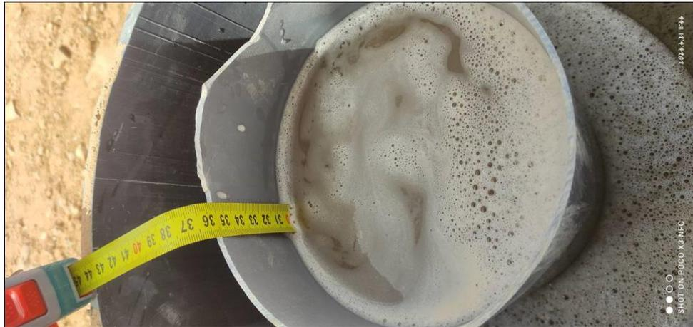
Figure 28 Mesure le niveau d'eau après le remplissage des anneaux
