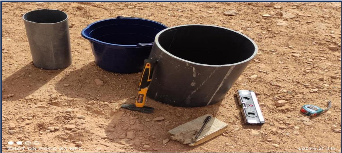
**Figure 27** Matériel utilisé pour le test d'infiltration
