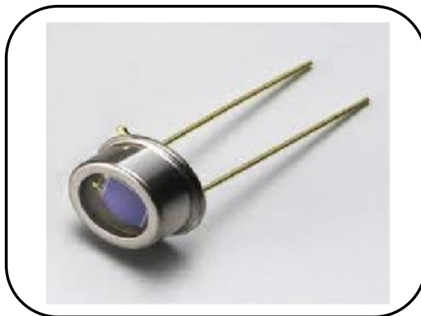
Figure II.11 : Un récepteur optique (photo détecteur).
