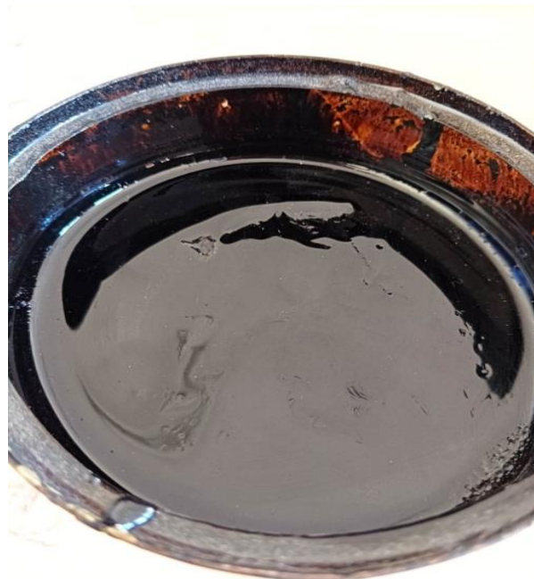
Figure IV.1: Échantillon de bitume pur 40/50
