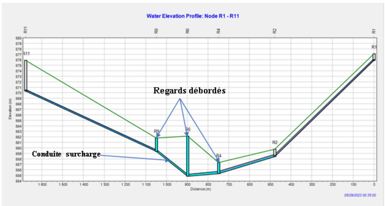
**Figure IV.20** : Profil en long du tronçon R1-R11
