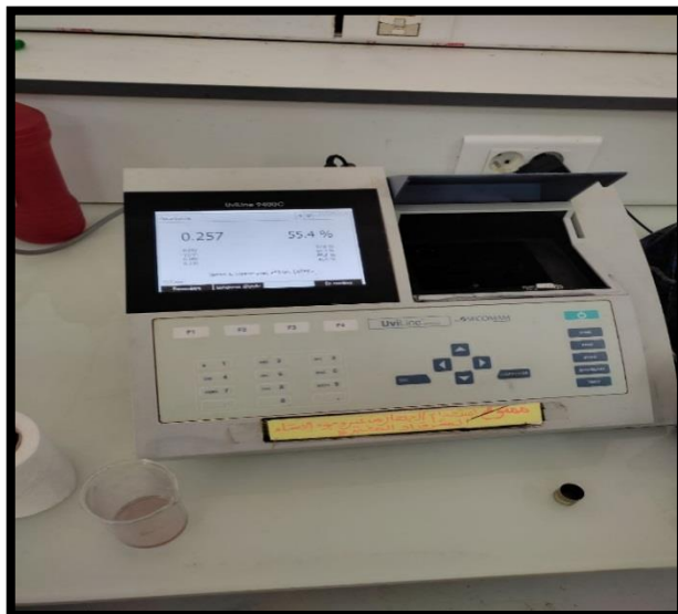
L'absorbance est lue par UV visible à 517 nm.
