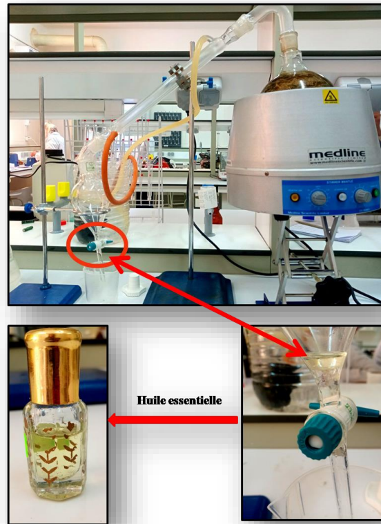
Figure19 : Montage d'extraction des huiles essentielles.
