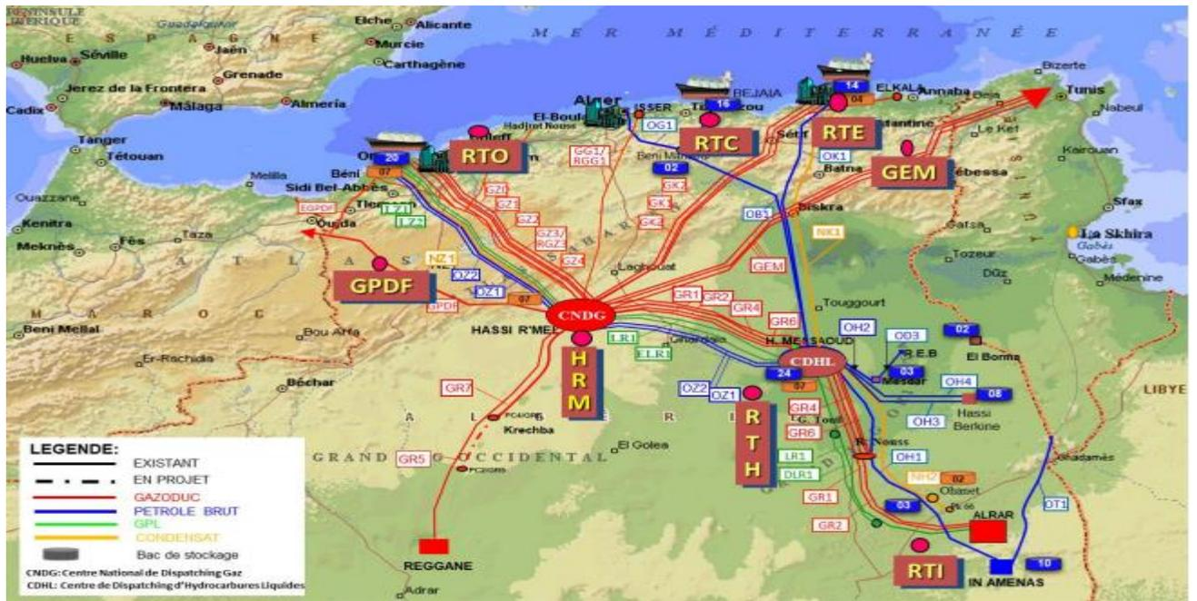
Figure 7 : réseau de transport par canalisation des hydrocarbures [29]
