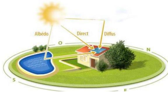
**Figure 1-8** : Composants du rayonnement solaire : extraterrestre, Globale = direct + diffus + albédo. [4]
