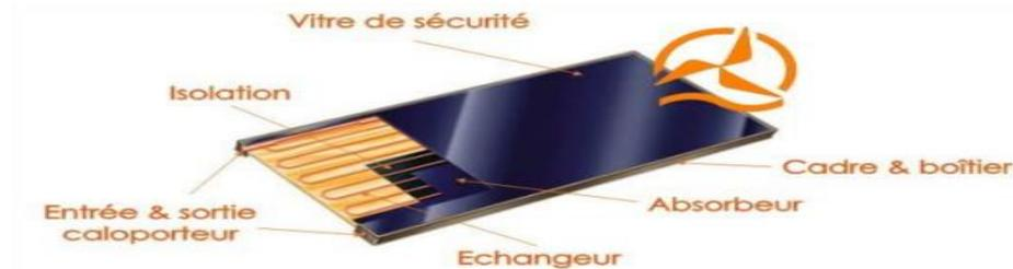
**Figure 2-3 :** Capteurs solaires thermique à eau. [6]
