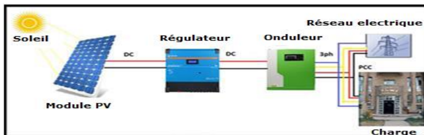
Figure 2-11 : Système solaire photovoltaïque.
