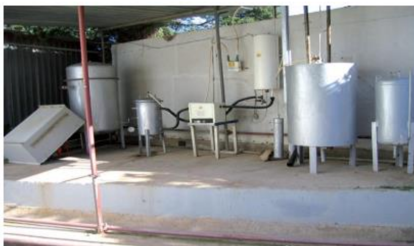
Figure 1-18 : Dispositif expérimental de production de biogaz, division Bioénergie et Environnement, CDER.
