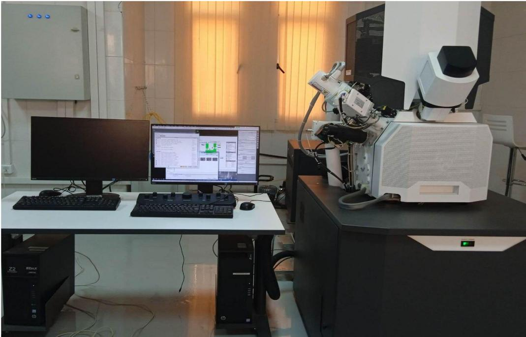
**Figure II.21:**Appareille de MEB couplé à l'EDX
