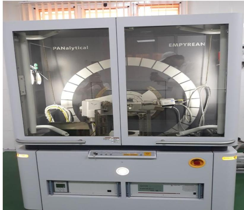
**Figure II.19 :** photo de diffractomètre DRX
