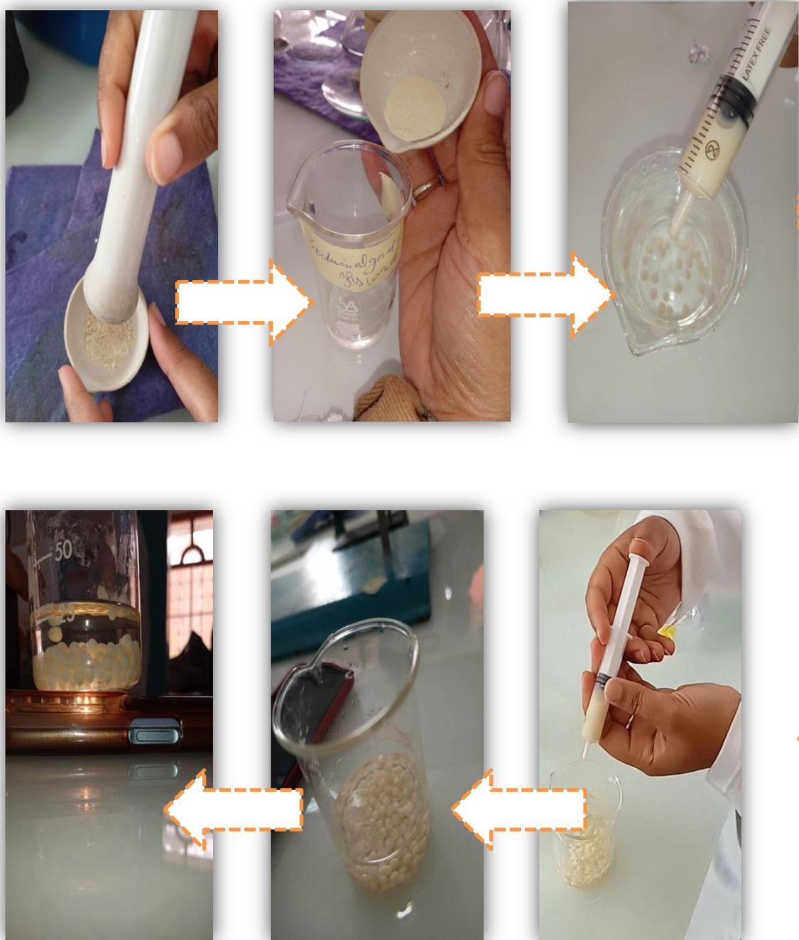
**Figure II.8** : étape de préparation des Billes d'alginate de ZnONPs
