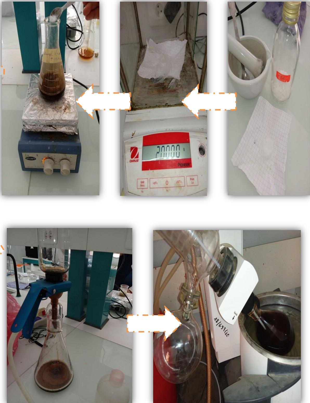
Figure II.10: traitement d'huile lubrifiante usagée pour obtenir une nouvelle huile
