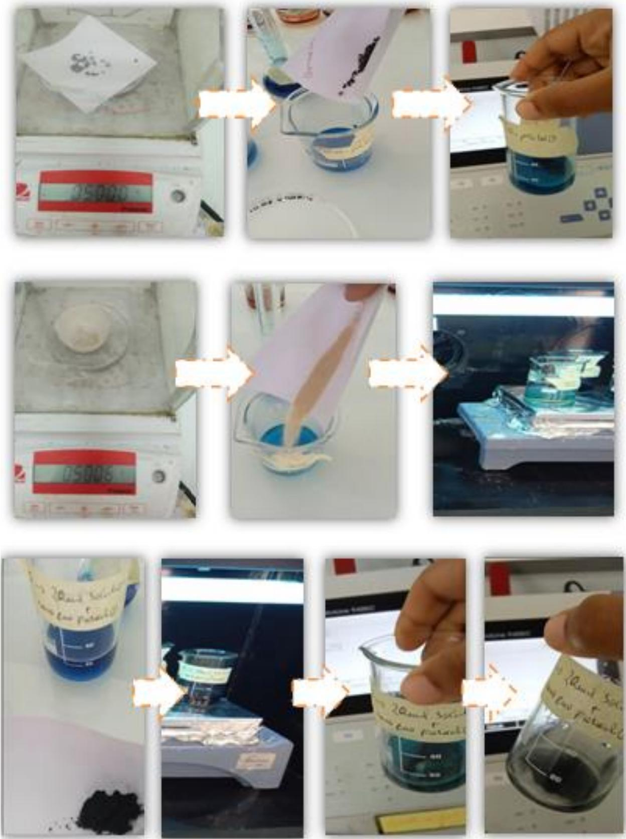
**Figure II.16:** Application des CuONPs, ZnONPs et les billes dans la photodégradation
