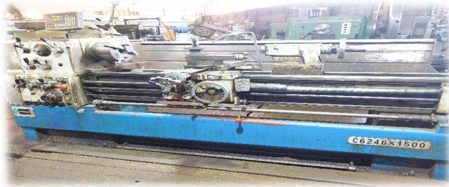
Figure. III.9. Tours parallèles à charioter et à fileter (S250)
