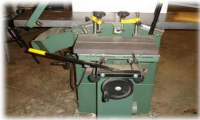
**Figure. III.5. Raboteuse**
