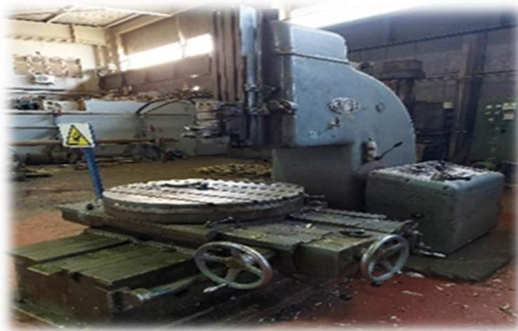
**Figure. III.6. Mortaiseuse**
