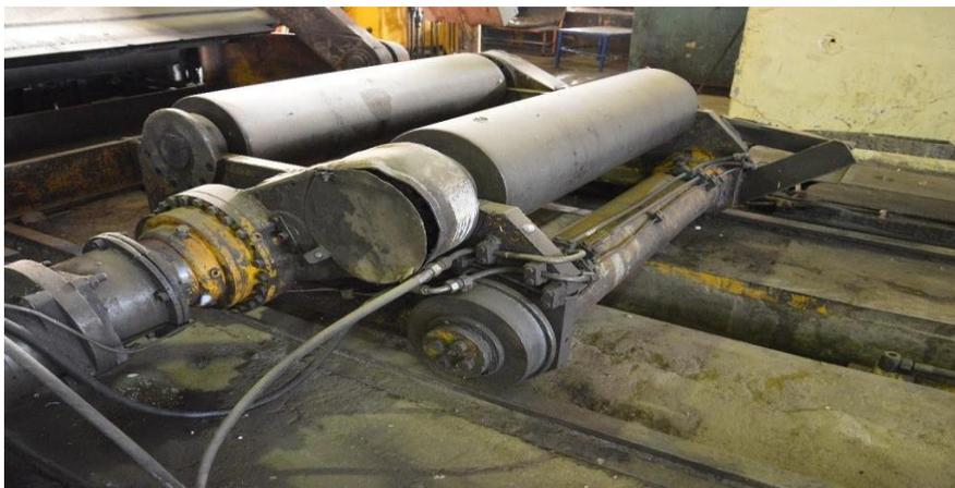
**FIG III.2.** Une photo prise de Chariot de rotation bobine.
