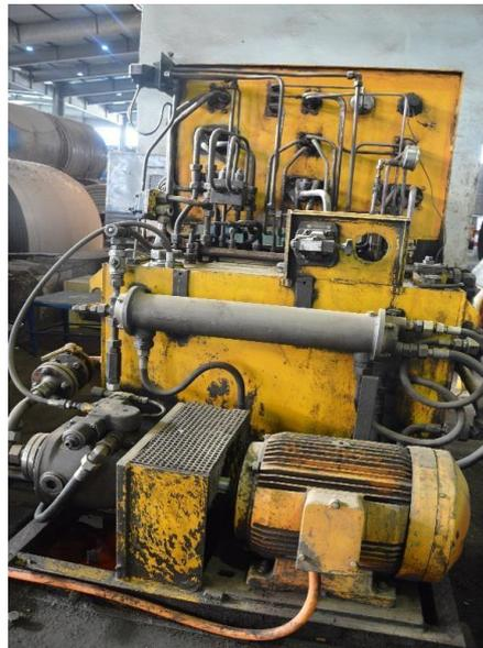
FIG III.10. Une photo prise de Groupe Hydraulique.
