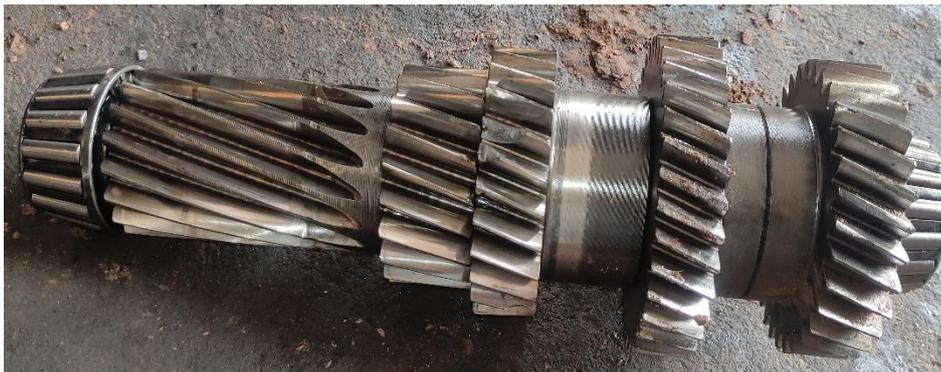
**Figure I : 19.arbre secondaire avec des synchros et des pignons**
