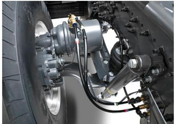
Figure I : 26.Système de freinage pneumatique
