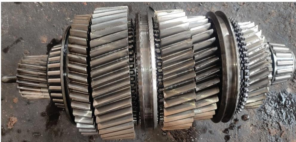
**Figure I : 17.arbre primaire avec des synchros et des pignons.**
