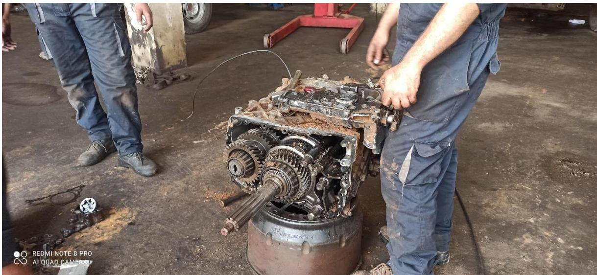
Figure I : 13.la boîte vitesse ZF dans TRUCK TEC
