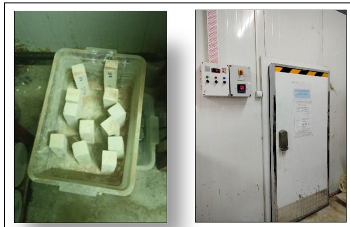
Photo. II.25. Conservation à une température ambiante au laboratoire (LTPS)
