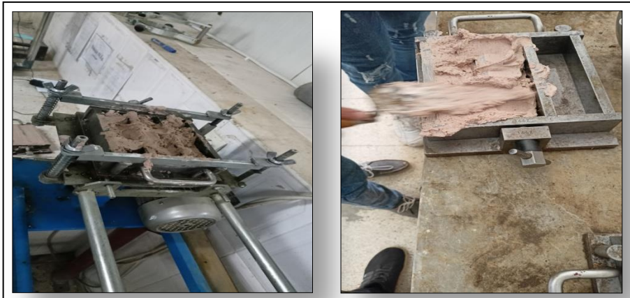
Photo. II.22. Coulage et Compactage des moules
