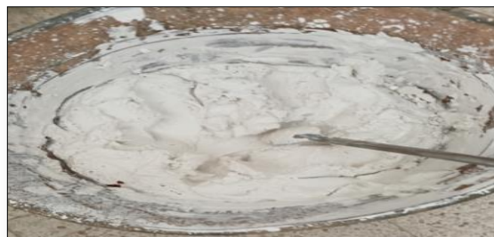
Photo. II.20. Le mélange de la chaux (LTPS)
