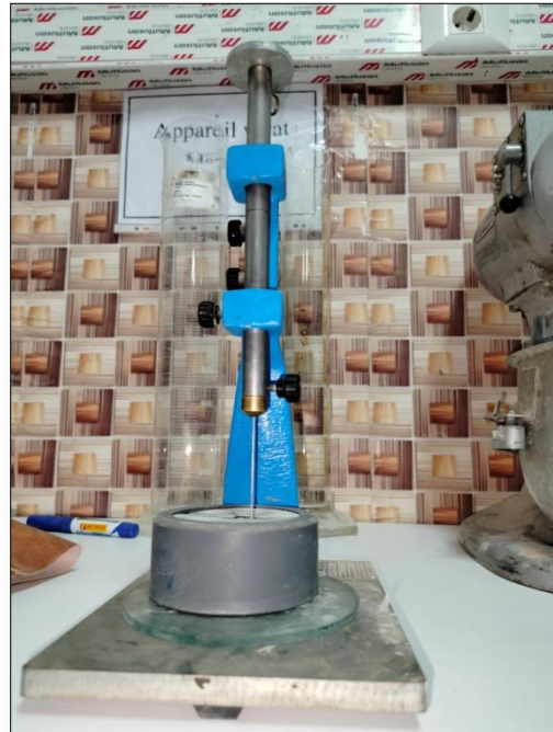
Photo. II.4. Détermination des délais de prise avec l'Appareil de Vicat (LTPS)
