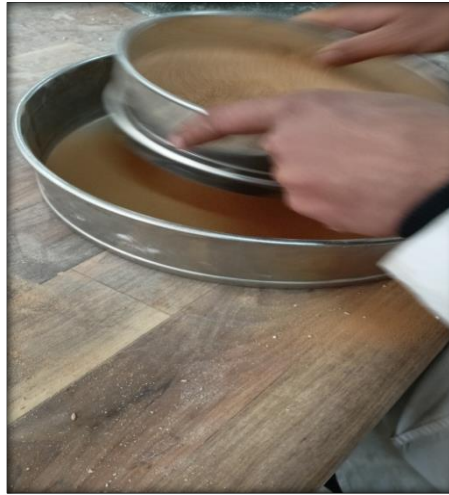
Photo. II.8. Mélanger manuellement du tamis (LTPS)
