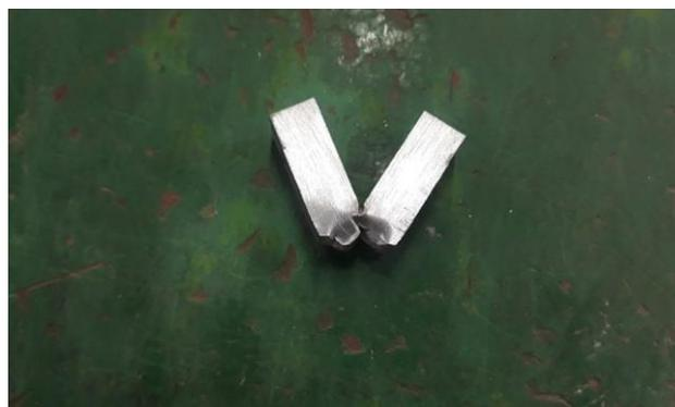
**Figure IV.5 : Éprouvette après rupture**
