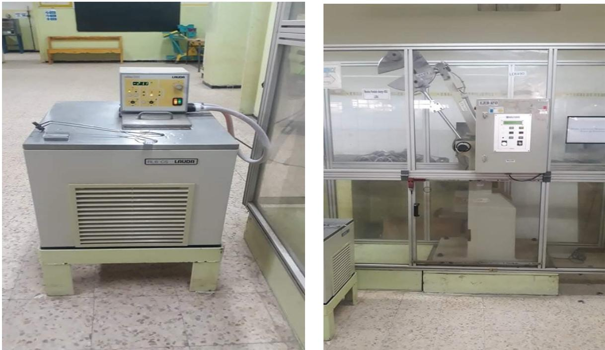
**Figure III.14** : Machine essai de résilience
