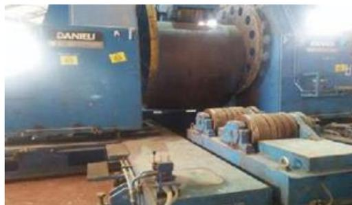
**Figure I.8 :** Machine de préparation de bobine
