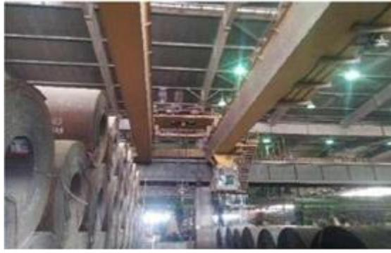
**Figure I.9** : Le pont roulant
