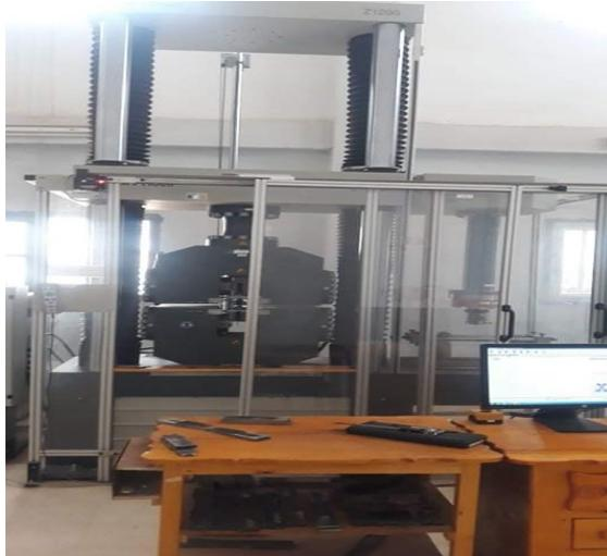
**Figure III.8:** Machine pour essai de traction
