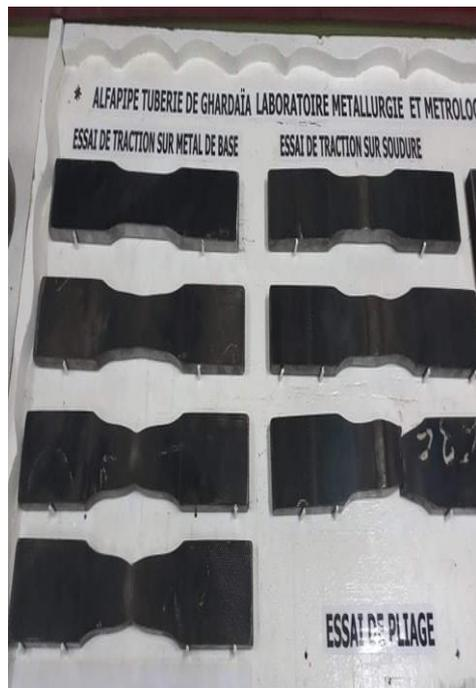
**Figure III.4:** TS traction sur soudure
