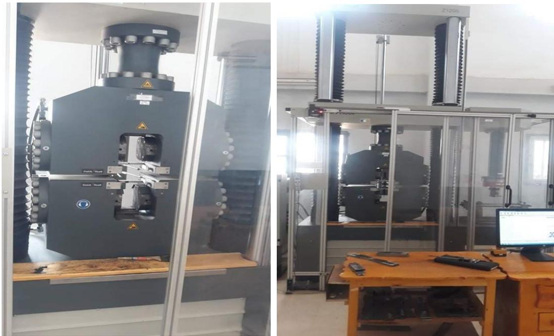
Figure III.7 : Machine essai de traction
