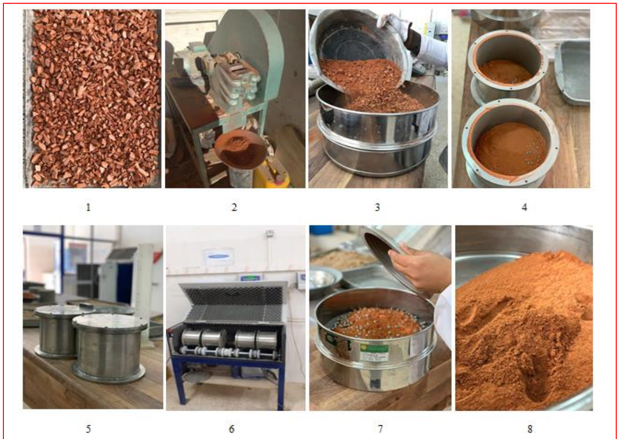
Figure II.2. Étapes de préparation la poudre déchets de briques.
