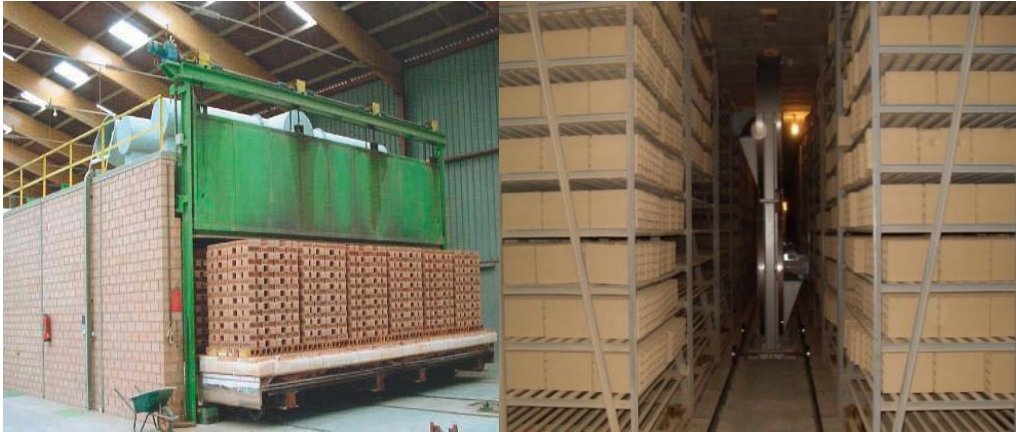
FigureI.10. Séchage de briques [68].
