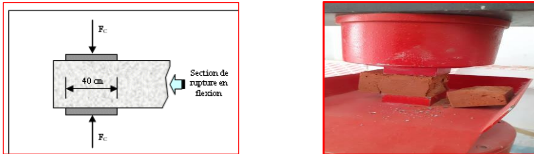
Figure II.21. Dispositif de rupture en compression [78].
