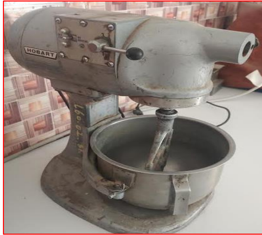
Figure II.16. Malaxeur électrique utilisée dans la fabrication du mortier [service de Béton –LTPS].
