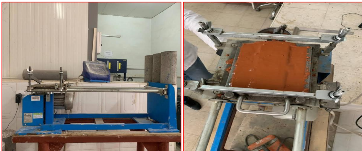
FigureII.17. Le moule est rempli et installé sur la table d'impact.
