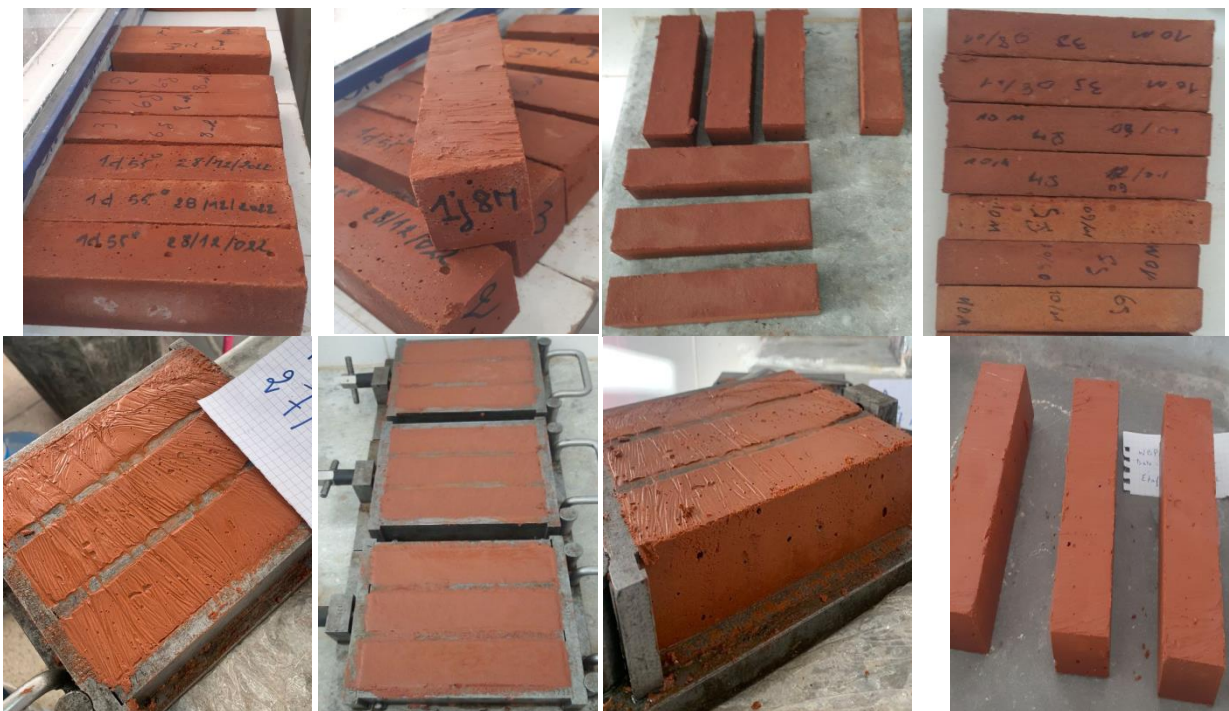
La Figure III.1 présente des images de mortier geopolymère.
