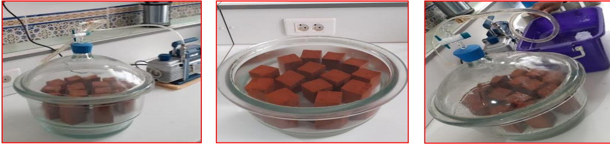
Figure II.24. Montage pour la mesure de la porosité accessible à l'eau à LTPS.
