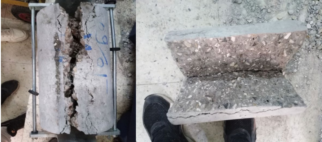
Figure 39 photo d'éprouvette après traction par fendage
