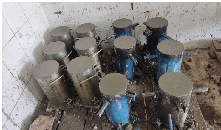
Figure 31 photo des échantillons du béton
