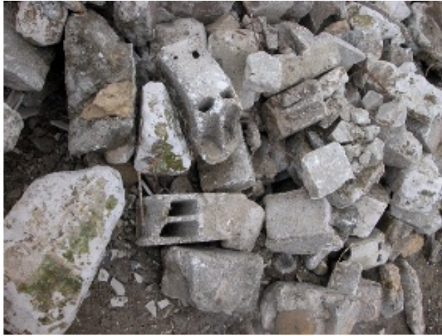
Figure 6 Granulats de débris de maçonnerie
