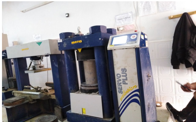
Figure 35 photo de Machine de compression de béton
