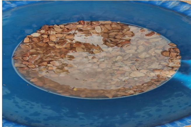
Figure 21 Gravier recyclé trempé dans l'eau
