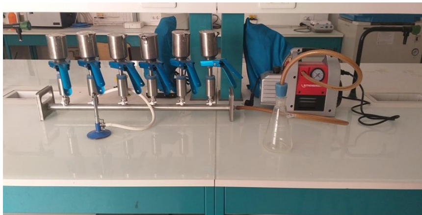
Photo 3. Rampe de filtration en acier inoxydable à 06 postes. (Original).
