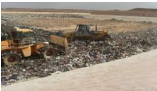
Figure 09. Compactage par compacteur et récupération de lixiviats dans un bassin de stockage
