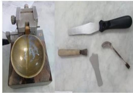
**Figure II.3 :** Appareil de CASAGRANDE Avec son équipement (Dahma, 2020)
