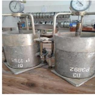
**Photo II.9** : Préparation d'essai CBR imbibé
