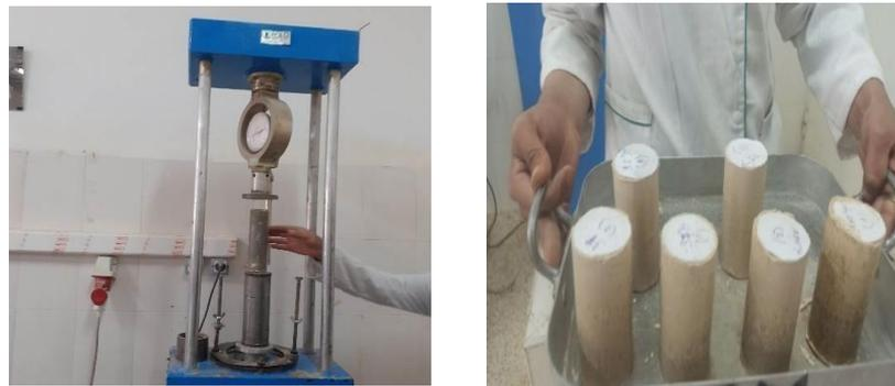
**Photo II. 11** : Essai de Compression simple de Fines calcaire
