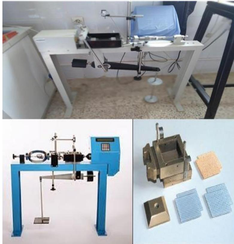
**Figure III.8** : L'appareil de cisaillement (Chenini, 2021).
