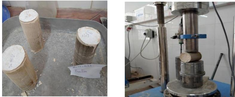
**Photo II.12** : Essai de traction de Fines calcaire
