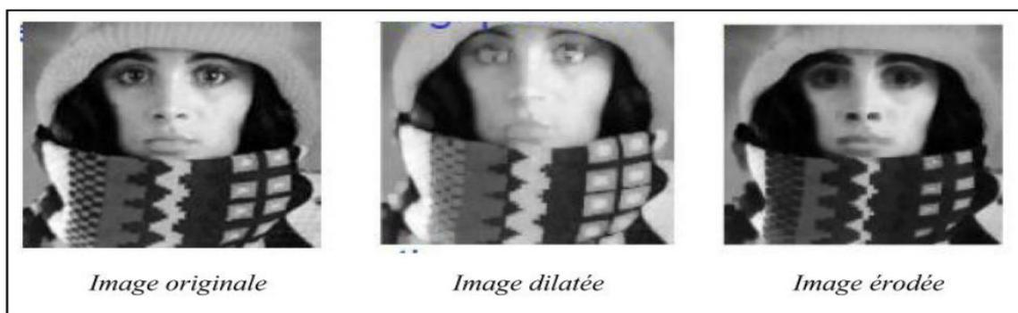
Figure II.18 : Effet de la dilatation et de l'érosion sur une image. [5]
