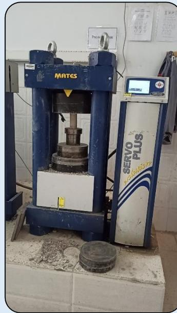
Figure 42: essai d'écrasement
