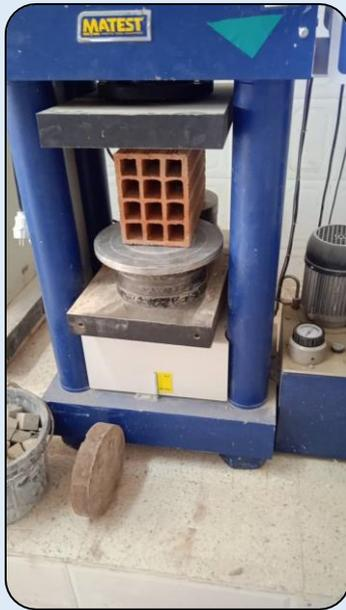
Figure 43: essai d'écrasement
