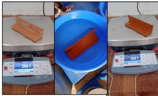
Figure 39: Etapes de mesure du pourcentage d'eau absorbée par les briques
