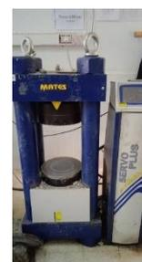
Figure 18: machine d'essai de compression
