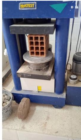
Figure 35: Essai de compression (LTPS)
