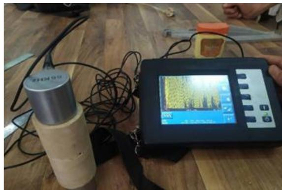
Figure 47: essai ultrason sur la pierre
