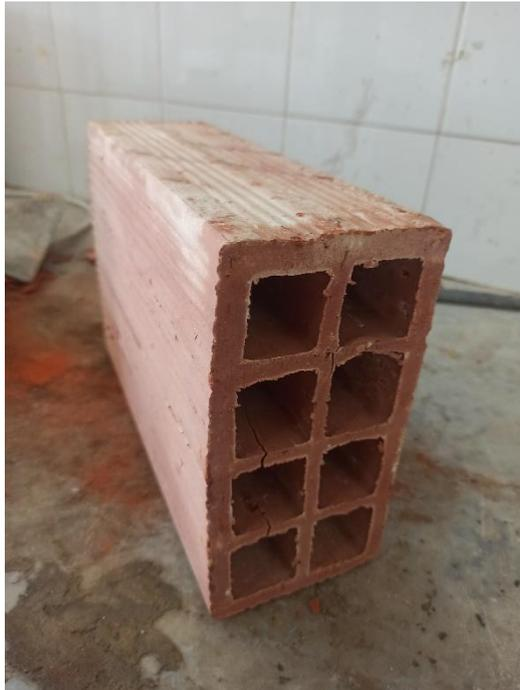
Figure 17: briques creuses B8
