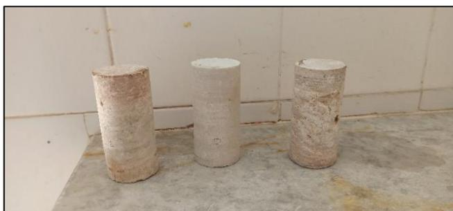
Figure 19: échantillons de pierre Cylindrique (5 \*10 cm)
