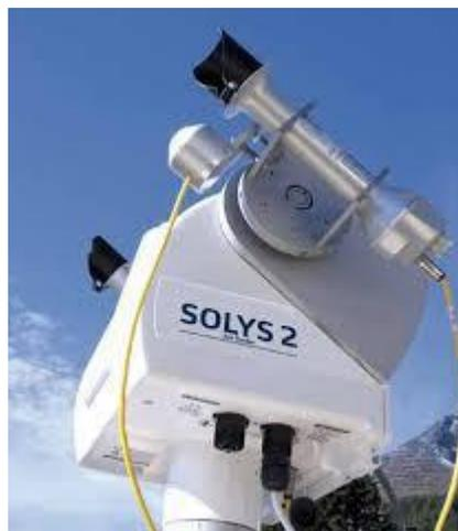
Figure II.9 : l'instrument pyrhéliomètre
