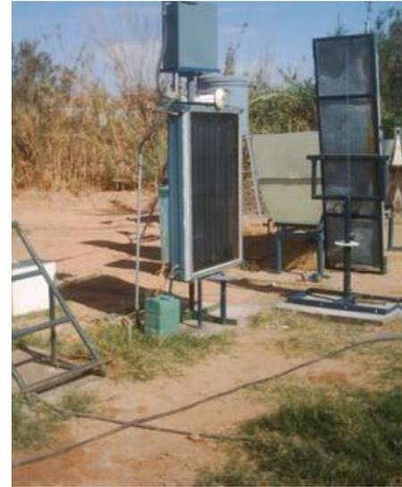
**Figure II.7 :** Distillateur solaire vertical
