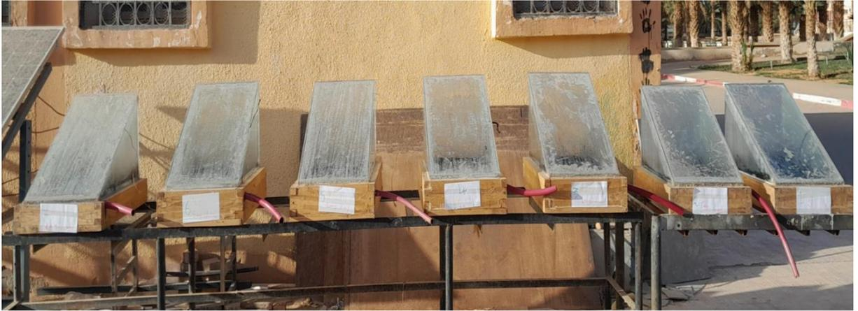
Figure III.1. Les sept distillateur utilise
