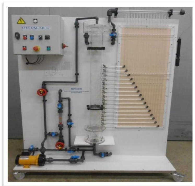
Figure N° 15: Schéma de filtre à sable (bande d'essais au la oratoire)
