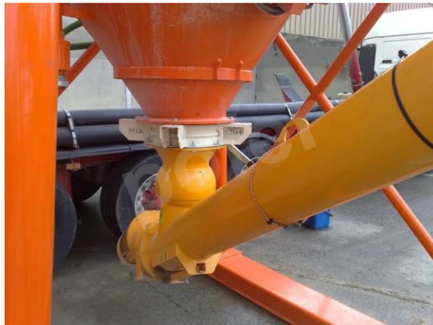
**Figure I-9 : convoyeur à vis par ciment**
