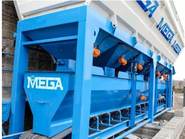
Figure I-7 : Bande de pesage sous la trémie
