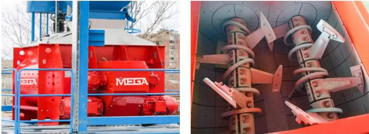
**Figure I-6 : Malaxeurs à béton**
