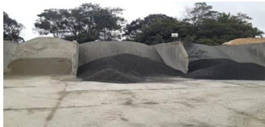
Figure I-1 : Pré-stockage des granulats dans des cases au sol.
