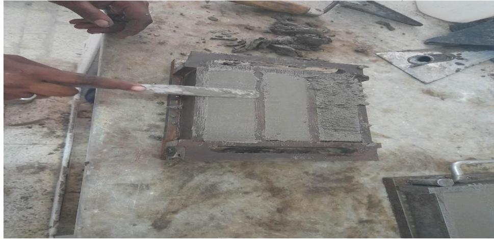
**Figure III-22 :** Nivellement de la surface du moule pour donner une surface lisse.
