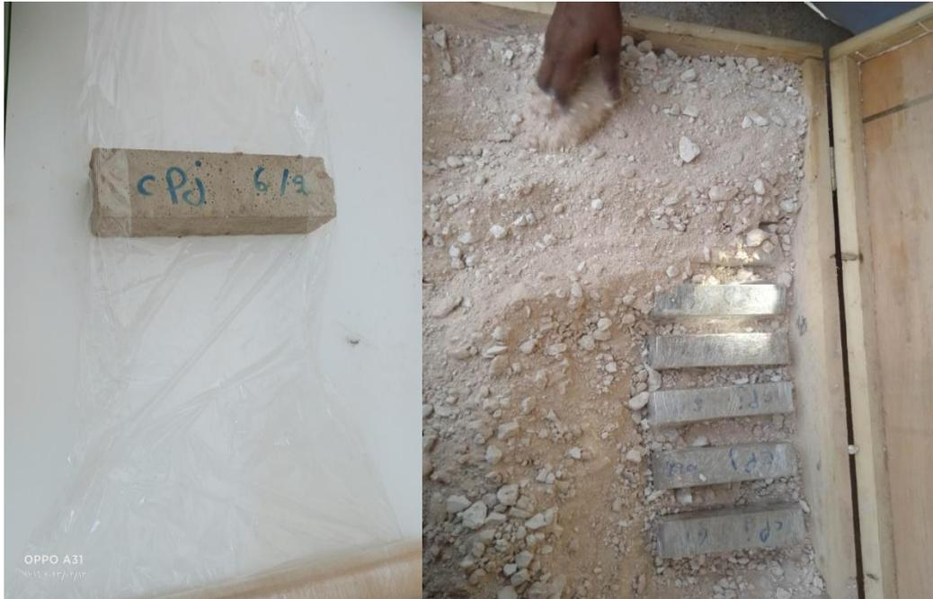
**Figure III-26:** Recouvrez les éprouvettes par un film de plastique et placez-les dans le milieu agressif.
