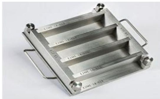
**Figure III-15:** moule de mortier.
