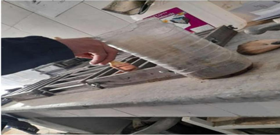
**Figure III-2** : Lubrification du moule.
