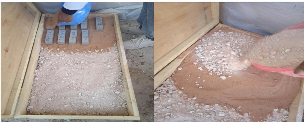
**Figure III-28:** Entourez et protégez les éprouvettes avec du sable à l'intérieur du milieu
