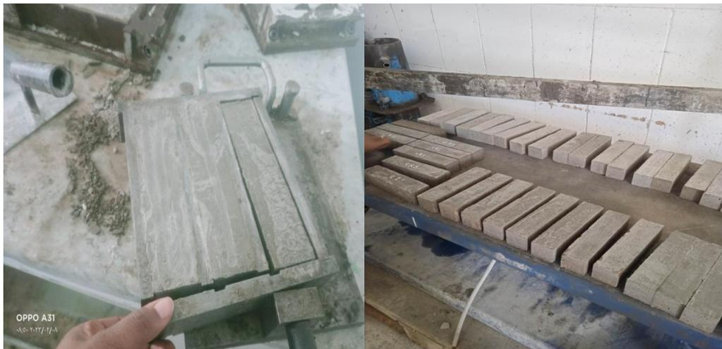
**Figure III-23 :** Démoulage Après séchage, enregistrez les informations dessus.
