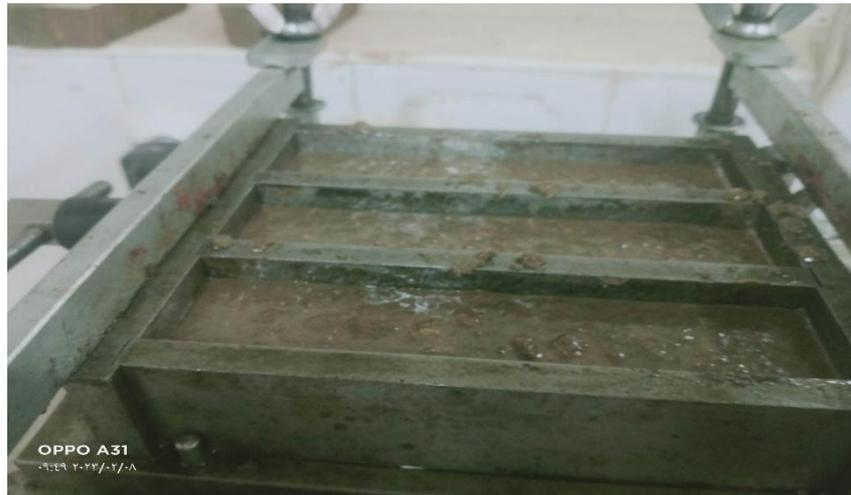
**Figure III-20 :** Mettre le mortier plus de la moitié du moule.
