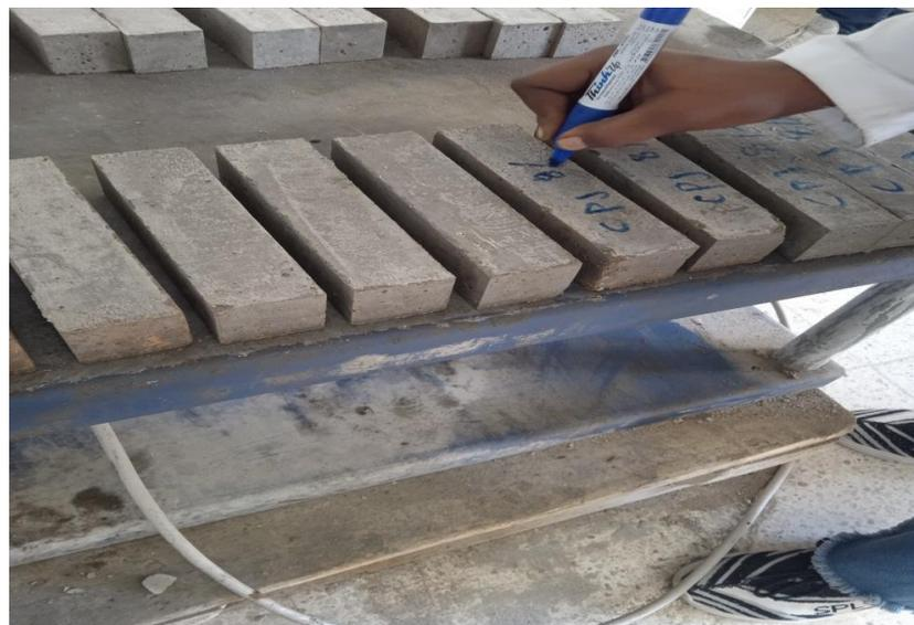
**Figure III-5 :** Rédiger des informations sur les moules à mortier.
