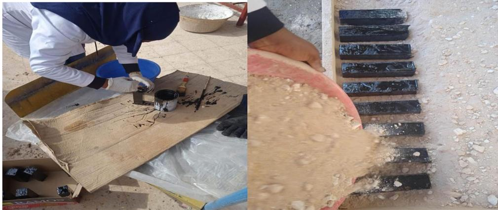
**Figure III-27 :** Peignez les éprouves avec bitume et lorsqu'ils sont secs, placez-les dans le milieu agressif.
