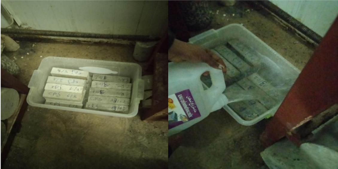
**Figure III-29:** Immerger les moules avec de l'eau et les placer dans la salle de conservation.
