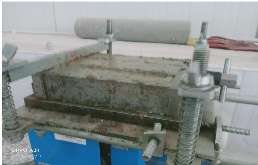
**Figure III-21 :** Remplir le moule de mortier.
