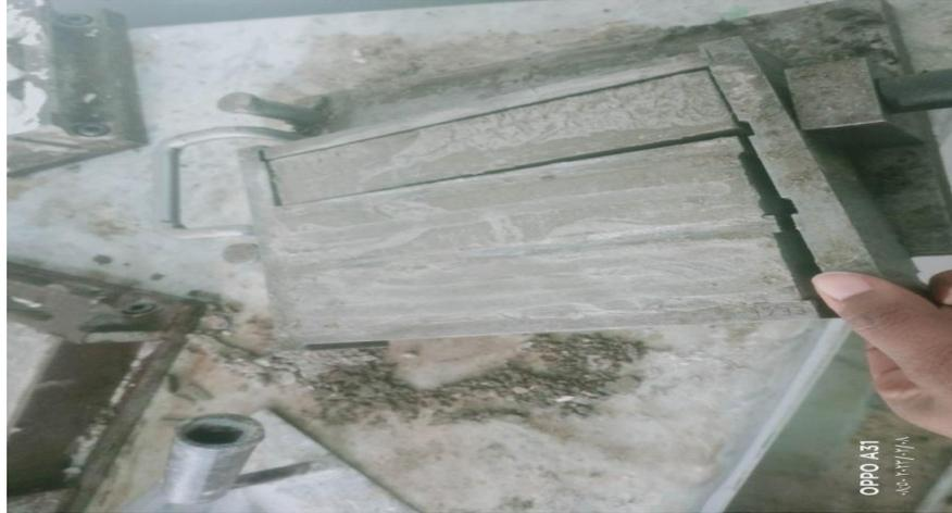
**Figure III-4 :** Démoulage des éprouvettes des mortiers.
