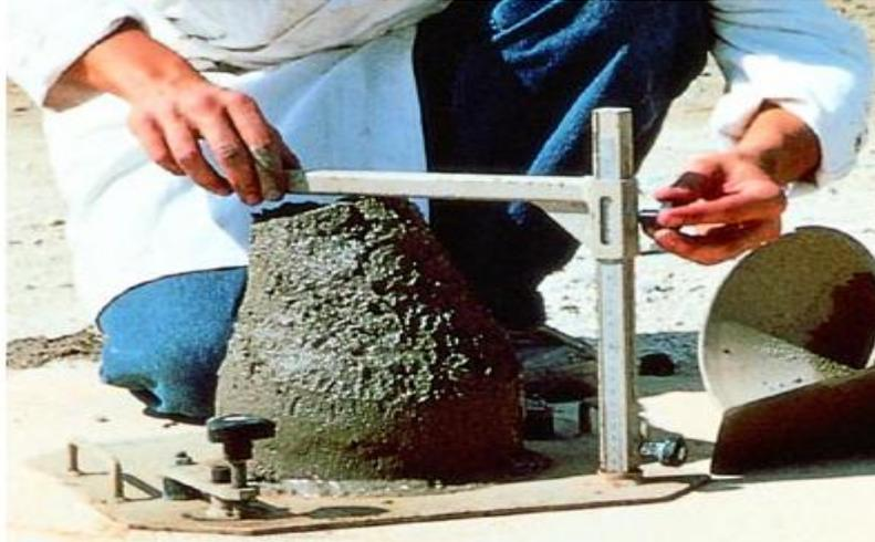
**Figure I-2** : cône d'Abrams [14].
