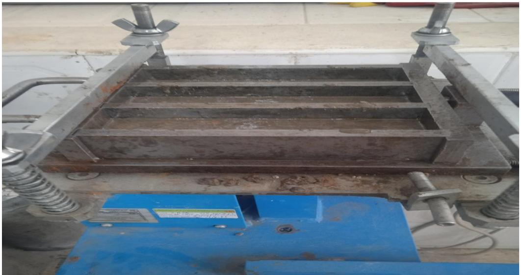
**Figure III-3** : appareil vibrant
