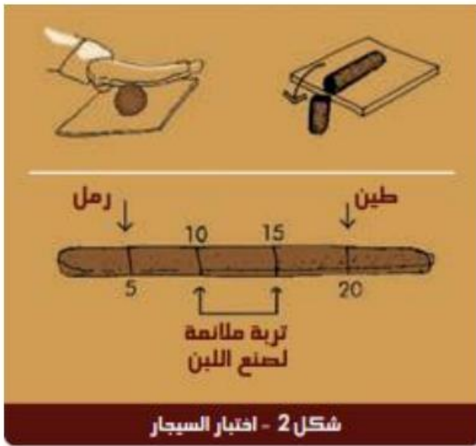
الشكل (4): شكل يوضح تجارب جودة الطين - اختبار السيجار [4]
