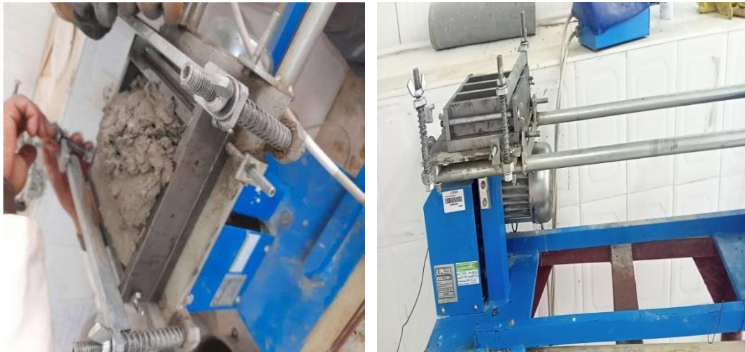
Figure III- 13 Remplir le moule et le mettre dans l'appareil à chocs (source auto)
