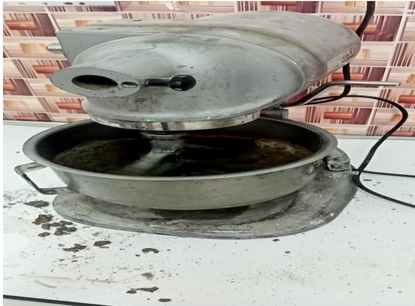
Figure III- 11 Malaxeur électrique utilisée dans la formulation du béton de sable LTPS source : auteur
