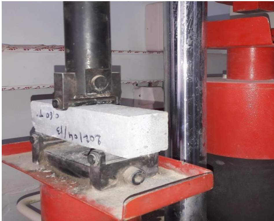
Figure III- 17 Dispositif de l'essai mécanique de rupture par flexion source : auteur
