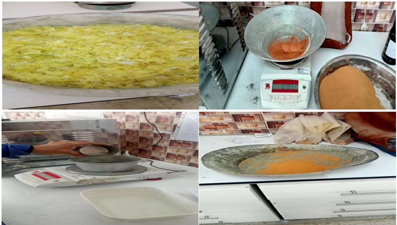
Figure III- 10 Pesage des composants du mortier source : auteur
