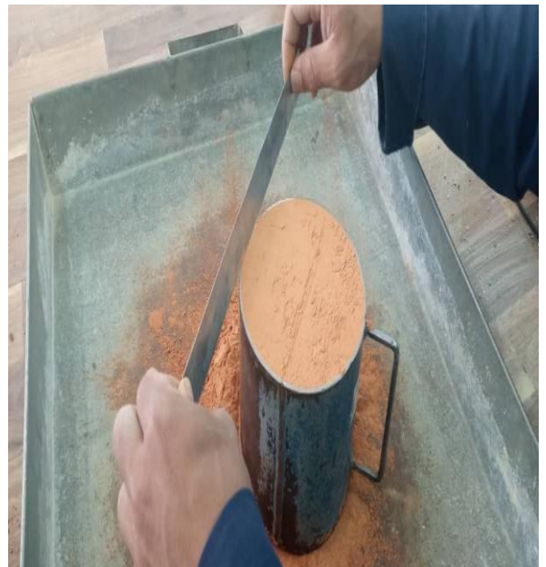
Figure III- 7 Masse volumique de déchet de brique à LTPS source : auteur
