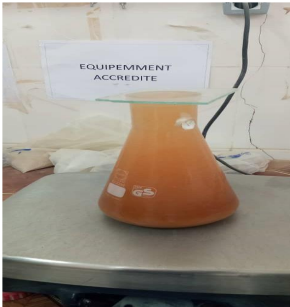
Figure III- 7 Masse volumique de déchet de brique à LTPS source : auteur
