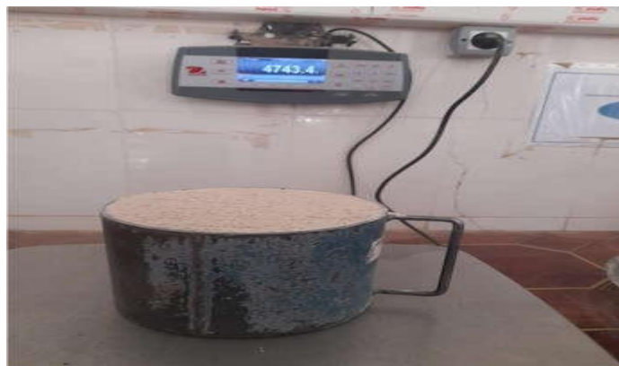
Figure III- 3 Mesure de la masse volumique apparente de sable source : auteur
