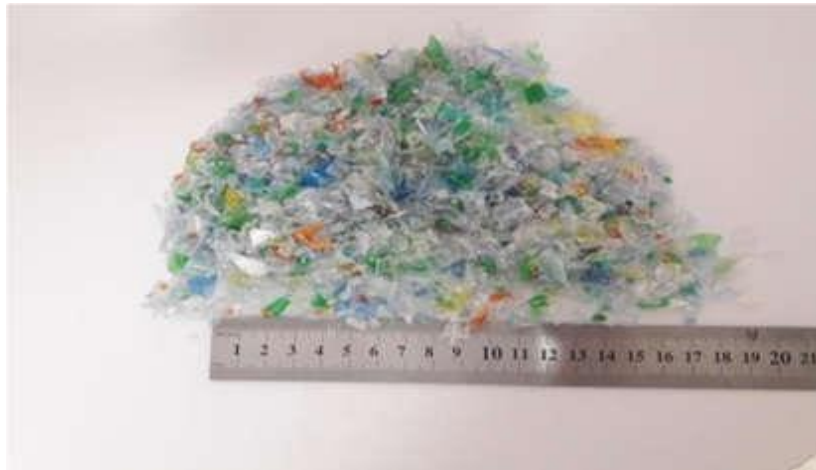
Figure II- 12 PET agrégats fins et PET agrégats grossiers [45]
