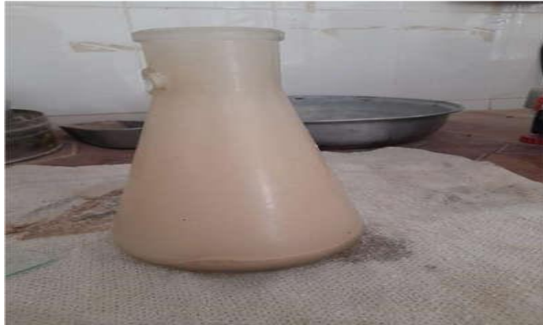
Figure III- 2 Essai de détermination de la masse volumique absolue source : auteur
