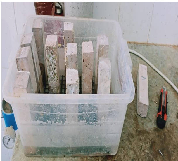
Figure III- 20 Essai d'absorption d'eau par capillarité source : auteur
