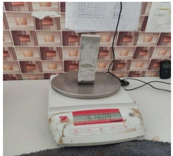
Figure III- 20 Essai d'absorption d'eau par capillarité source : auteur
