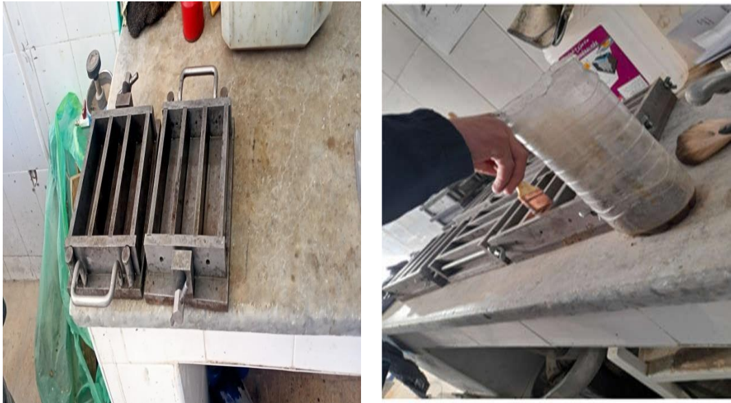
Figure III- 12 Moule normalisé de 4x4x16 cm 2 (source auto)
