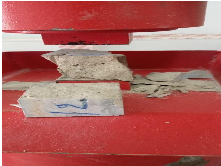
Figure III- 18 Dispositif de l'essai mécanique de Compression source : auteur
