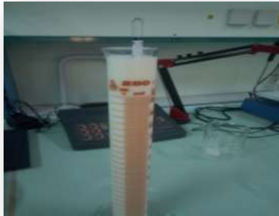
Figure 5 : la mesure de la densité par lacto-densitomètre
