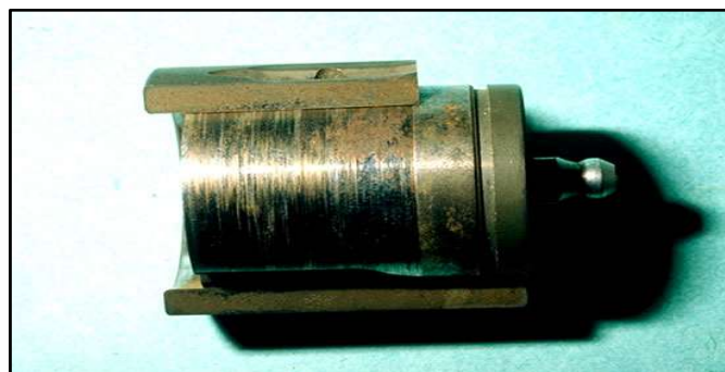
Figure 7 : corrosion par frottement. [f]
