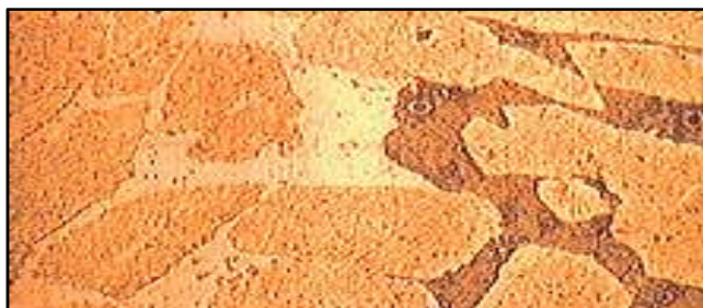
Figure 9: corrosion sélective [H]
