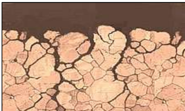
Figure 10 : Corrosion sous contraintes d'un alliage cuivreux [I]
