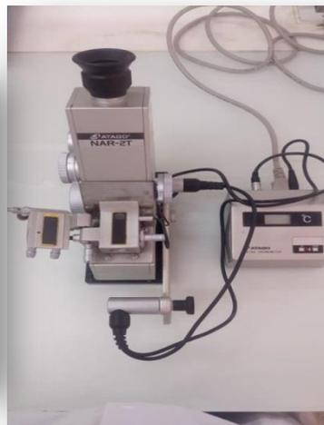
**Figure 16:** Réfractomètre
