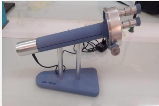
**Figure 15:** Polarimètre
