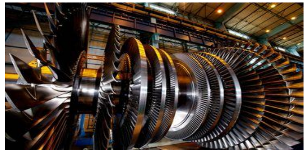
Figure 21 turbine à vapeur [18]
