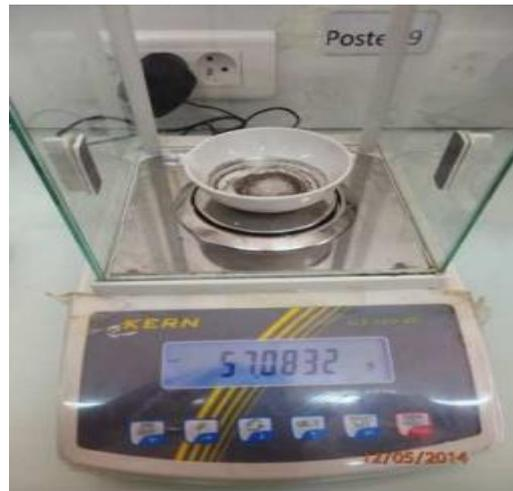
**Figure 14:** Creuset en platine contenant les résidus secs
