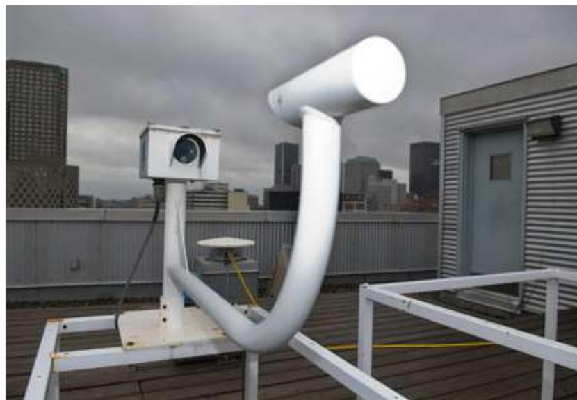
**Figure 2 : Les pluviomètres optiques**
