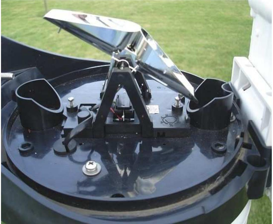
**Figure 4 - Les pluviomètres à auget basculeur**
