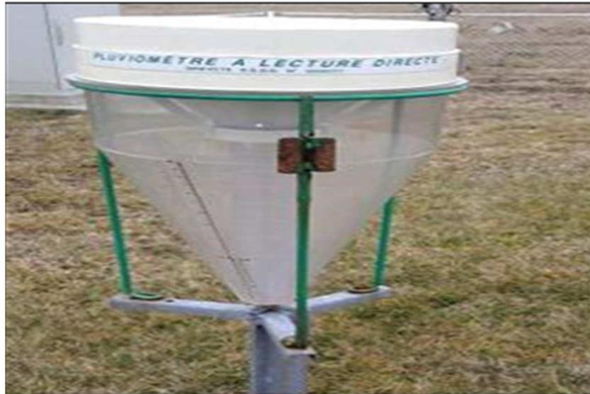
**Figure 1 Pluviomètres manuel**
