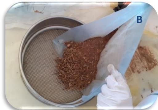
**Figure 11:** Préparation des échantillons aux analyses. **A** : Broyage, **B** : Tamisage (Moulay Lakhder et Morsli, 2020).
